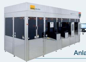
**Anlagen für Fotomaschinenreinigung**
